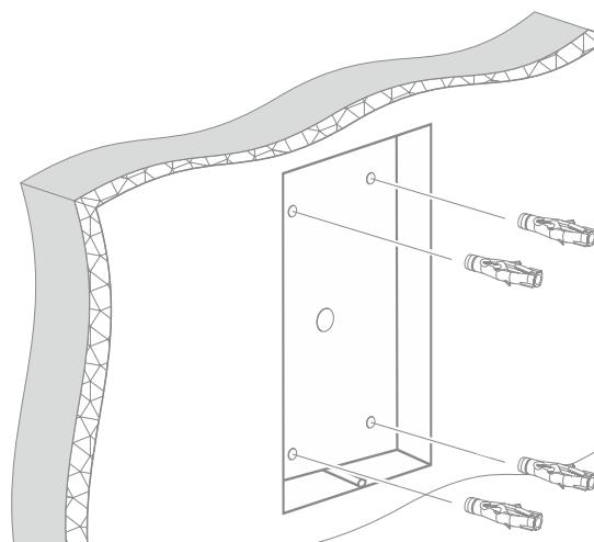
**9** Проложите все необходимые кабели для подключения и управления панелью: для Интернета, кнопку выхода, замок, питание панели, датчик двери, пожарную сигнализацию, интерфейсы RS485 и Wiegand — в нишу.
