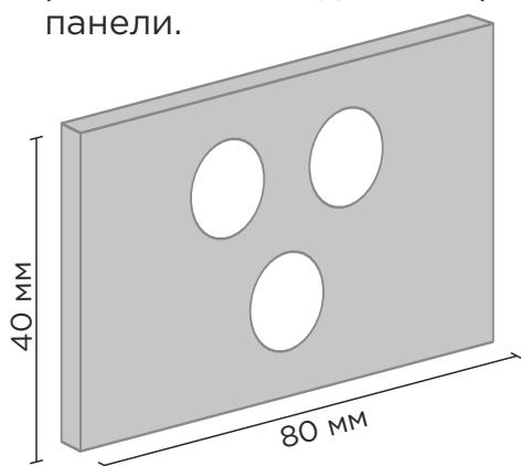
**12** Протяните все выступающие из стены провода через ранее сделанные отверстия в изоляционном прямоугольнике.
