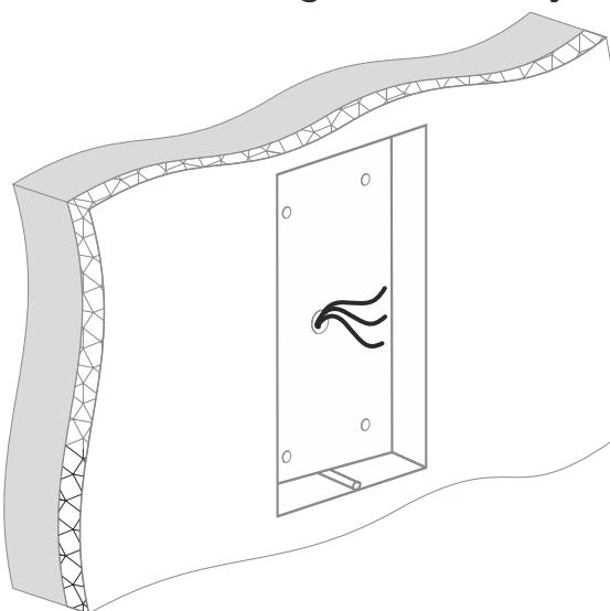
**10** Установите кронштейн для врезного монтажа в вырезанную нишу и закрепите его винтами через монтажные отверстия.
