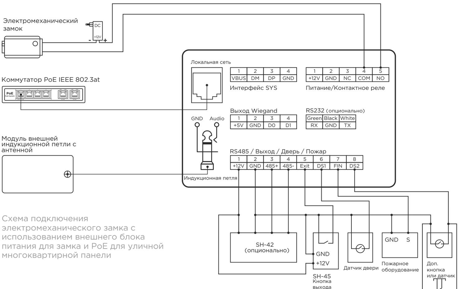
Схема подключения электромеханического замка с использованием внешнего блока питания для замка и PoE для уличной многоквартирной панели
