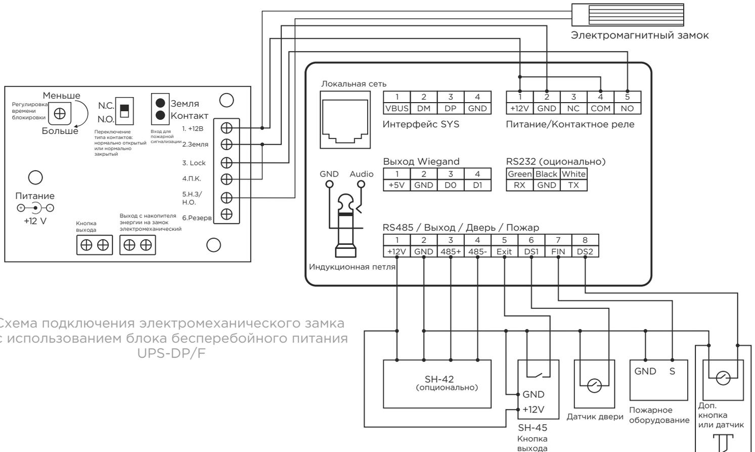
Схема подключения электромеханического замка с использованием блока бесперебойного питания UPS-DP/F
