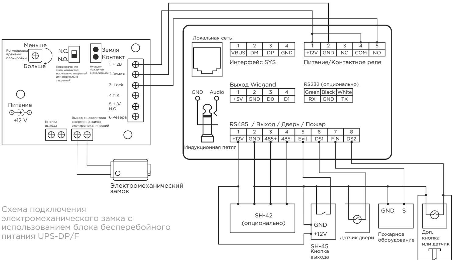
Схема подключения электромеханического замка с использованием блока бесперебойного питания UPS-DP/F
